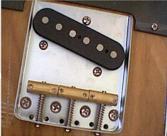
Aquí vemos el puente ya encordado, y un par de vistas en las que se aprecia perfectamente el radio del mástil y las silletas del puente ajustadas siguiendo dicho radio.
